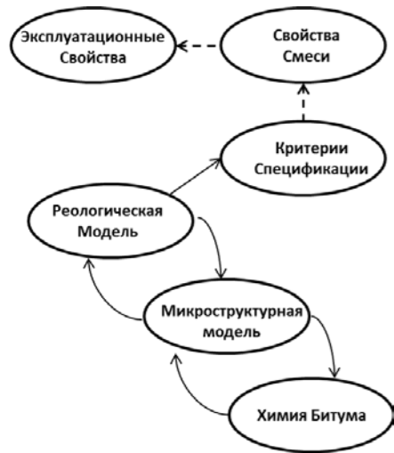
Рисунок 1. (Схема 3.5. [14]) Отношения между эксплуатационными, реологическими и микроструктурными моделями свойств и химией битума
